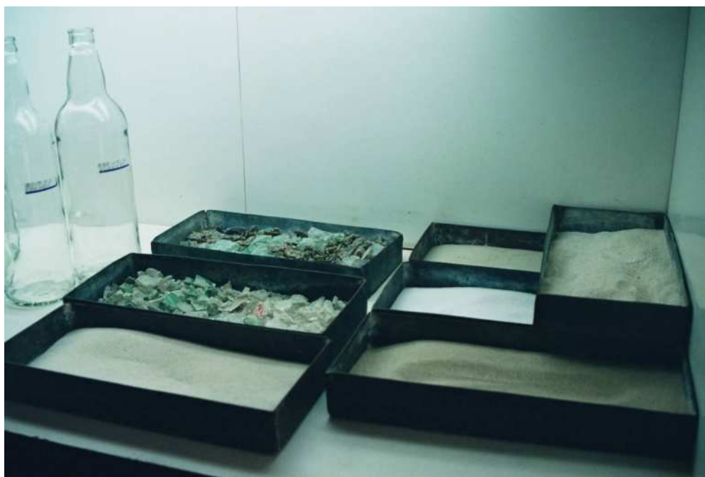
Foto 37 – Materias primas que componen el vidrio: arena 58%, barrilla 19%, calcáreo 17% y feldespato 6%
