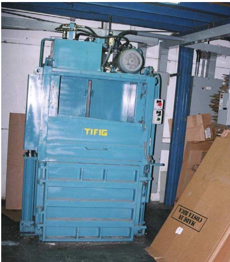
Foto 48 – Infraestructura, prensa de alta capacidad de compactación
