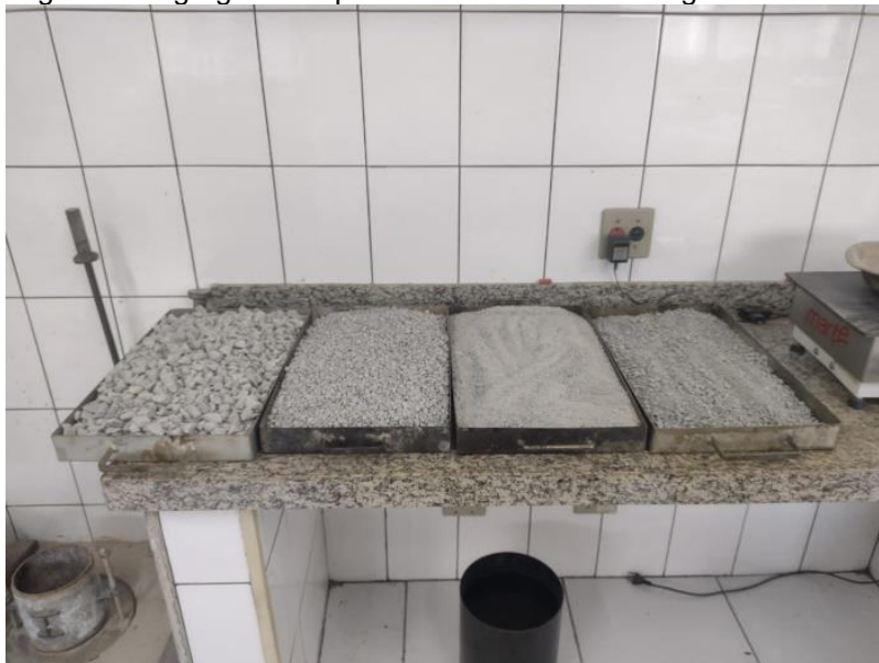
Figura 1 – Agregados separados conforme análise granulométrica.
