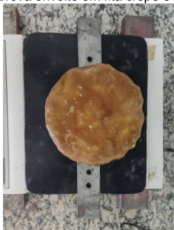
Figura 4 – Corpo de prova envolto em fita crepe e parafina sendo pesado.
